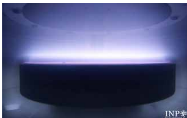
Magnetronspalterprozess zur Nanopartikel- und Schichtdeposition
