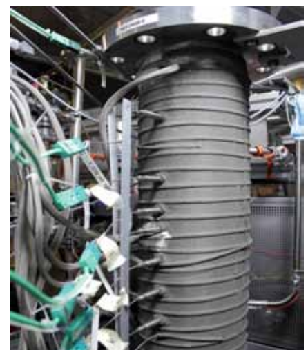
Dampfreformer für die Reformierung von Diesel am Prüfstand des OWI (Foto: OWI)
