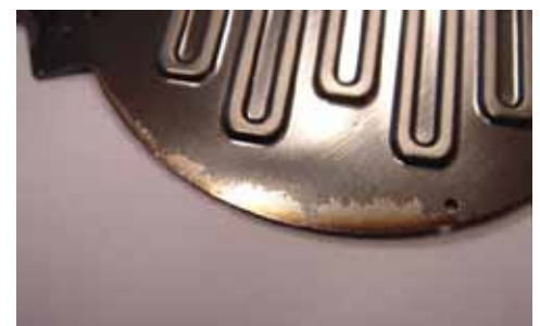
Ablösung der Beschichtung im Randbereich nach Auslagerung an einer Bipolarplatte
