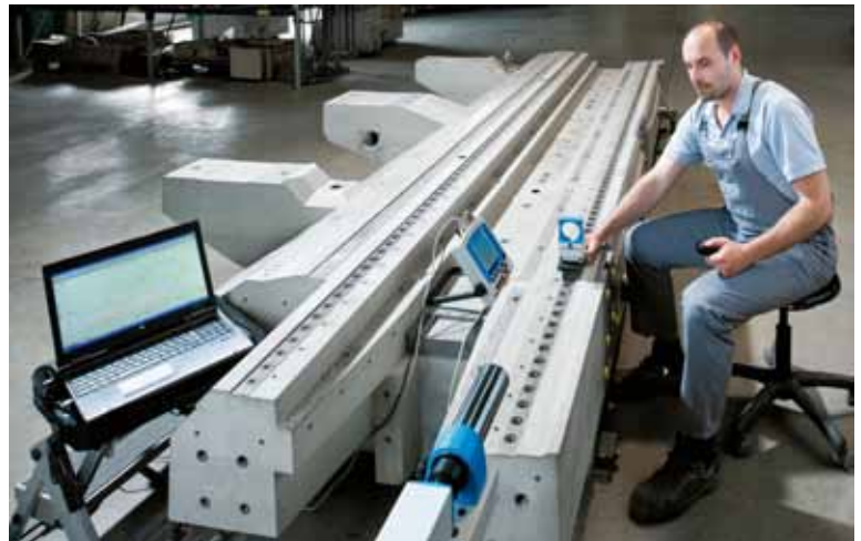
Präzises Vermessen nach hochgenauer Bearbeitung an einem UHPC-Maschinengestell
